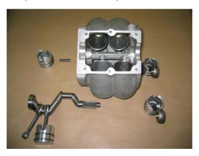
Dans un premier temps, visser les bouchons en laiton 10, sans serrer et sans le joint 11, sur les chemises. Dans chaque cylindre, mettre une rondelle d'épaisseur 5mm et de diamètre inférieur à 50 mm, pour éviter de mettre les segments dans les rainures des chemises lors de la pose des pistons.
